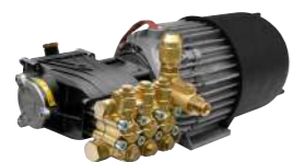
Motore a induzione e testata in ottone
